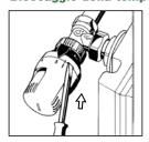
1. Ruotare la manopola in posizione tutta aperta (Pos. 5). Con l'aiuto di un cacciavite sganciare la ghiera spingendola verso il corpo valvola fino a battuta.
