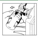
2. Ruotare la manopola fino alla nuova posizione di massima apertura desiderata (esempio pos. 3). Ruotare la ghiera in senso antiorario fino a battuta.
